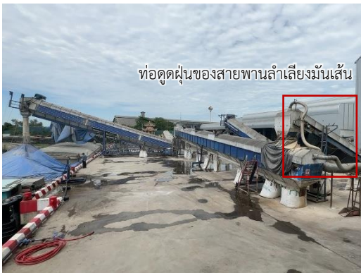
รูปที่ 2-7 เครื่องดักจับฝุ่น ติดกับโกรกลงสินค้า B พร้อมท่อดูดฝุ่นจากสายพานลำเลียงมันเส้น
