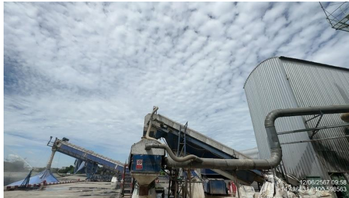
รูปที่ 2-27 การขนถ่ายสินค้าบริเวณโกรกลงสินค้า B และสายพานลำเลียงมันเส้นเข้าซึ่งเป็นระบบปิด
