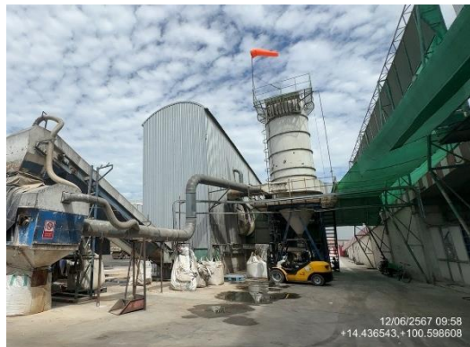
รูปที่ 2-7 เครื่องดักจับฝุ่น ติดกับโกรกลงสินค้า B พร้อมท่อดูดฝุ่นจากสายพานลำเลียงมันเส้น
