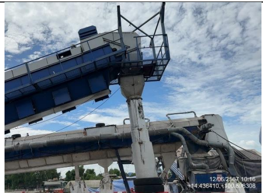
ท่อดูดฝุ่นจากผ้าใบเรือเข้าสู่เครื่องสายพานลำเลียงมันเส้น
